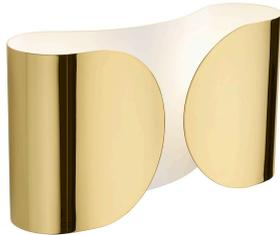
Applique à lumière directe/ indirecte/partiellement diffuse. L'attache murale est en acier tranché, plié et recouvert d'une peinture à poudre brillante de couleur blanche. Diffuseur en métal tranché, courbé et recouvert d'une peinture à poudre. Les deux supports douilles sont en Nylon (PA6) moulé par injection de couleur blanche.
