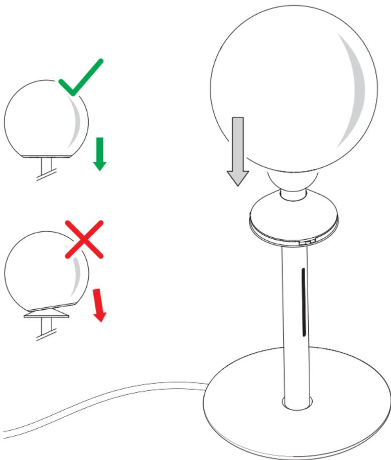
Base festhalten und mit der anderen Hand die Glaskugel im Uhrzeigersinn bis zum Einrasten festdrehen.
